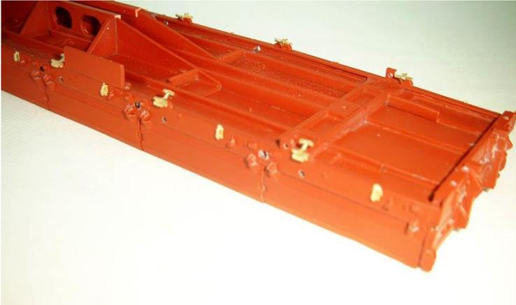
Der Messing Kleinkram wie Luftkessel, die KE-GP Bremsanlage, der Bremszylinder, mit Last und Bremsschalter werden an die Unterseite geklebt.
