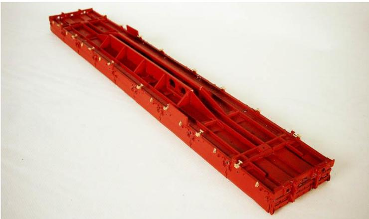
Die angegebene Locher für die Rungen und die Puffer werden gebohrt.
