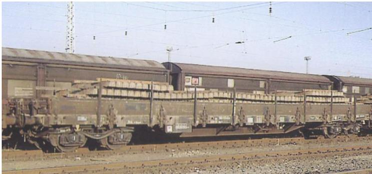
*Der Bausatz der Rungenwagen Gattung Res 687, aufgelegt bei MOSPAT ist hier als Grund genommen für den Umbau, die eine Ersetzung der Drehgestelle umfasst, eine geänderte Beschriftung und Anstrich. Dieser Ausführung einer Res 686 trägt Y25 Drehgestelle.*
