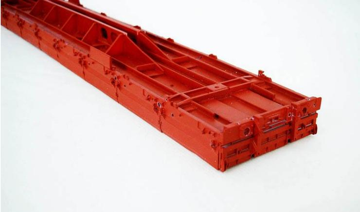
Nachdem werden Verriegelungs- Handgriffe für die Rungen montiert und die Messing Bindeösen angeklebt.
