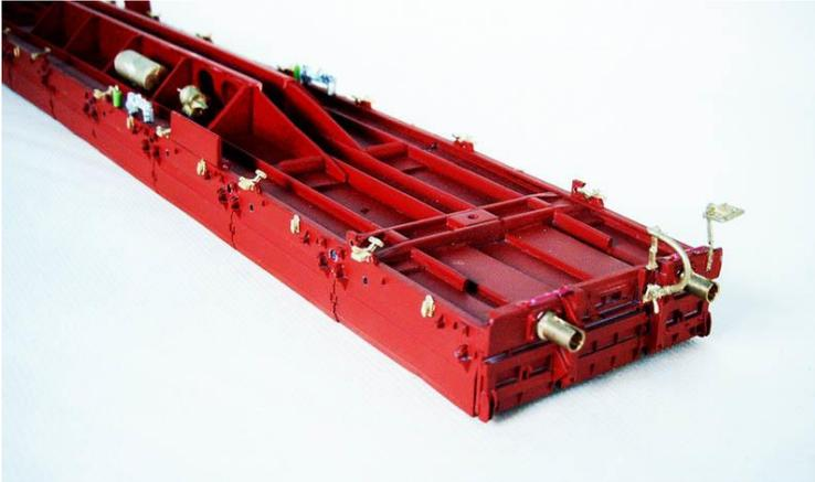
Das Gehäuse wird weiter bestückt mit andere Messing Kleinkram, wie Klap Stütz Griffen, Rangiergriffe etc.
